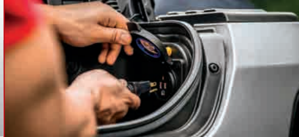
115-VOLT POWER OUTLET
